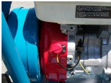
**Fig. 7** Interrupteur d'arrêt
