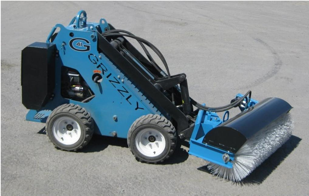
Ce balai de 44" balaye droit devant, à gauche ou à droite selon vos besoins. La vitesse de rotation de la brosse est variable permettant un balayage rapide pour pousser au loin les débris ou la neige et peut balayer à faible rotation pour maintenir les débris tel que les roches près de la brosse.
