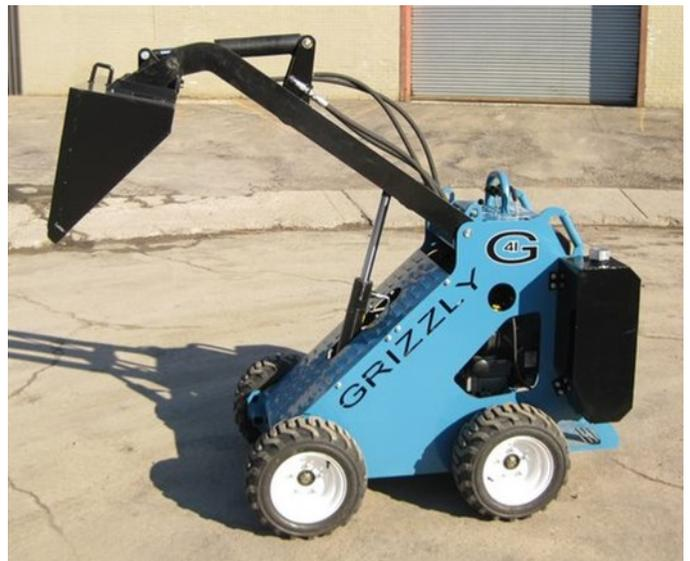
Le G41 est muni de 4 moteurs-roue hydrauliques indépendants à entraînement direct, ce qui élimine l'utilisation de chaînes de transmission.
