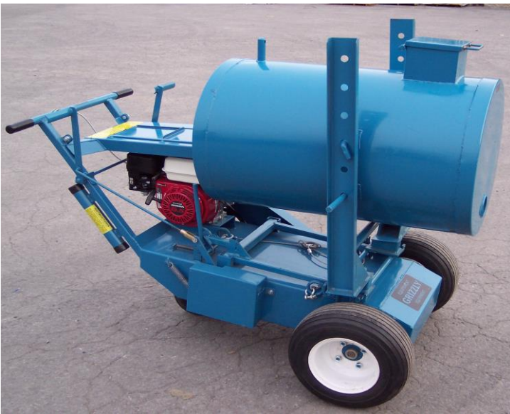
Fig. 7 Avec réservoir d'asphalte chaud
