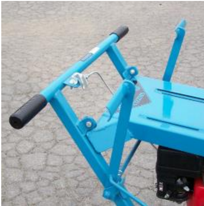
Fig. 3 Levier de frein appliqué et embrayage désengagé
