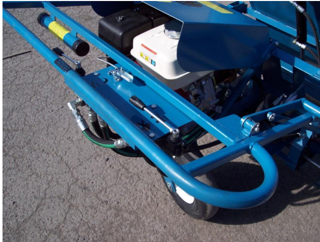
Fig. 9 Tous les leviers sont au neutre, le frein verrouillé
