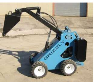
Le G41 est muni de 4 moteurs-roue hydrauliques indépendants à entrainement direct, ce qui élimine l'utilisation de chaines de transmission.
