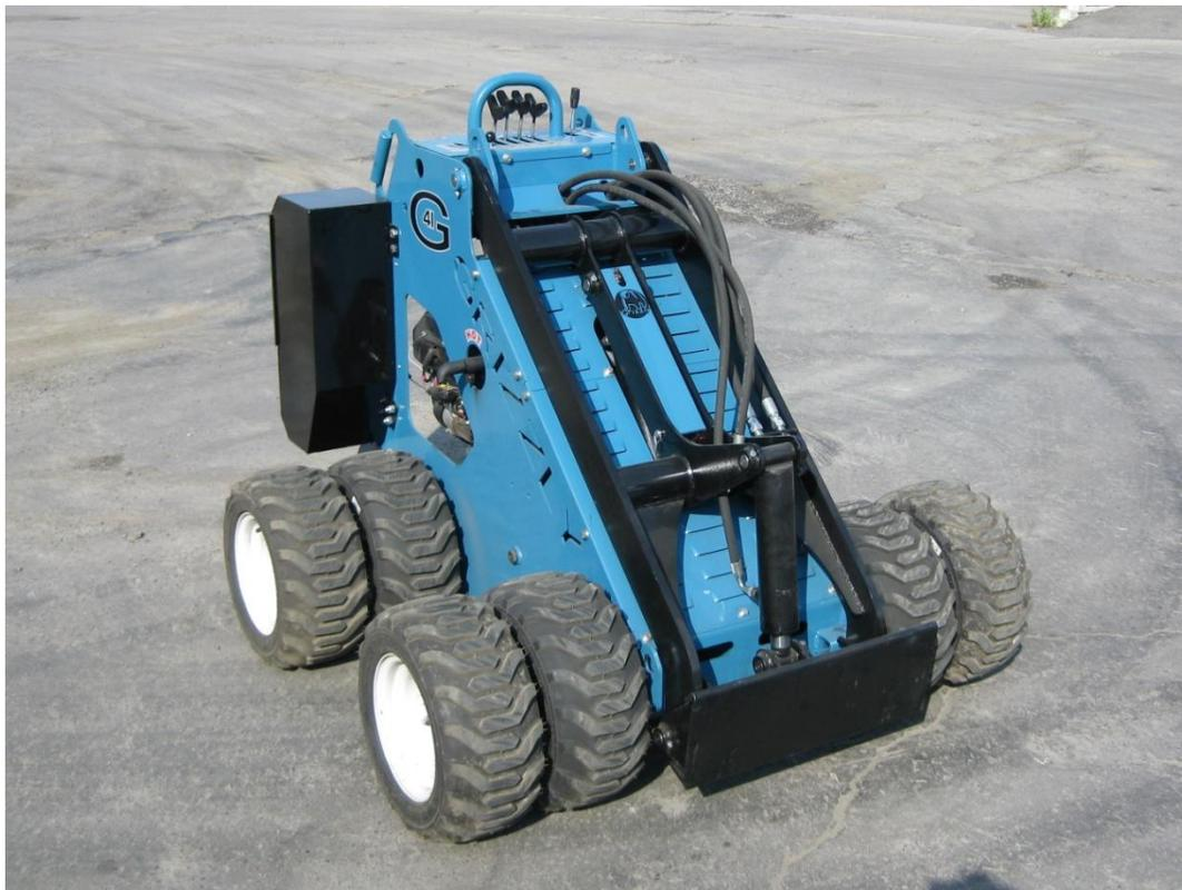
Facile à assembler et à désassembler, ce kit de roues doubles permet de mieux répartir le poids de la machine de façon à pouvoir travailler sur des surfaces molles ou fragiles. L'opérateur doit toutefois s'assurer de la solidité de la surface sur laquelle il doit travailler.
