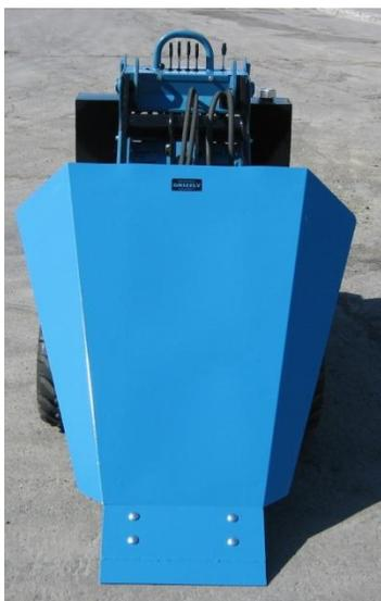
Cette arracheuse permet de passer sous le matériel et de le soulever sur sa plaque afin que l'on puisse le prendre pour en faciliter la manutention.
