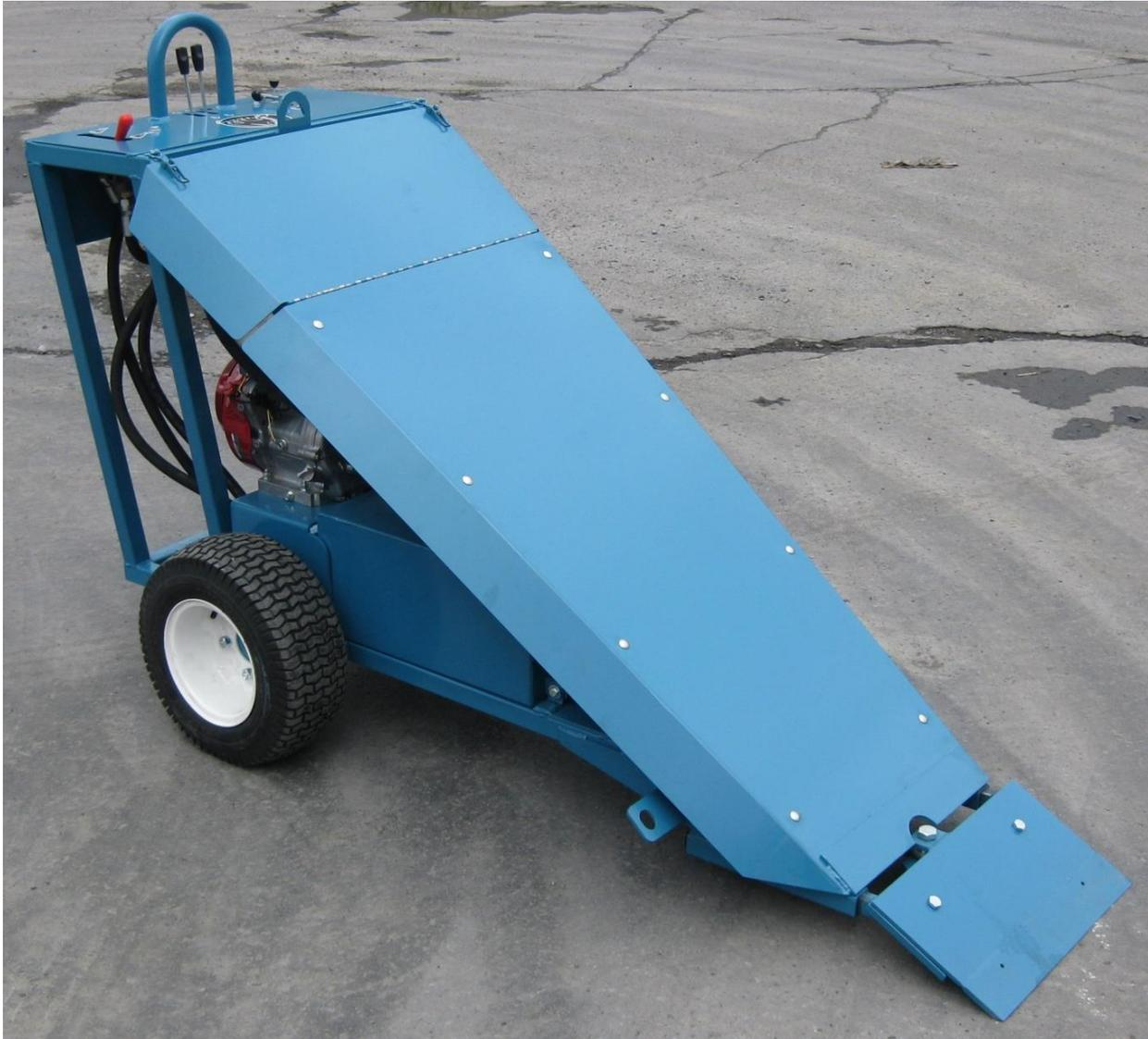
Un sélecteur contrôle l'activation de la lame et une valve d'écoulement contrôle le débit que l'opérateur désire diriger vers les roues ou la lame d'arrachage, s'ajustant ainsi au différent besoin d'arrachage.
