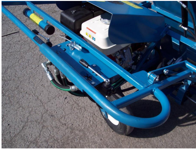
Fig. 9 Tous les leviers sont au neutre, le frein verrouillé
