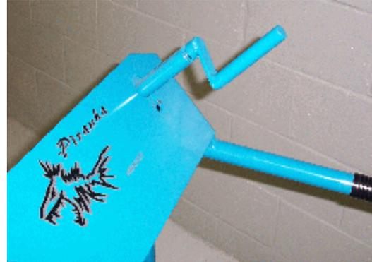
**Fig. 5** Levier d'ajustement en position d'opération
