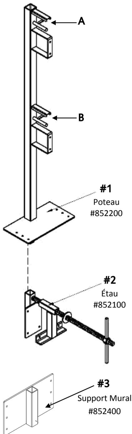
1- Installation du poteau seul #1: Nous suggérons de visser le poteau solidement au parapet à l'aide de vis tirefond 1/4"(6mm) de diamètre par 1-1/2"(38mm) de longueur **minimum**. Tous les trous doivent être comblés. Répétez la procédure sur chaque poteau en les installant à tous les 10 pieds(3m) centre à centre.
