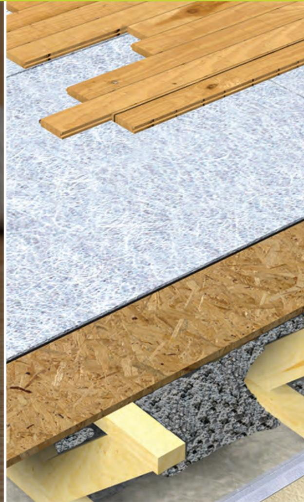
Le panneau ACOUSTIBOARD est un produit acoustique révolutionnaire qui permet d'éliminer les chapes de béton de 38 mm (1½ po) habituellement coulées sur les structures de bois tout en offrant des performances acoustiques exceptionnelles. Ainsi, les travaux peuvent être réalisés plus facilement, plus rapidement et à moindre coût. Vu sa faible épaisseur de 8 mm (3/8 po), il est facile d'utiliser l'ACOUSTIBOARD sur tout genre de structure, car il suffit généralement de le déposer.
